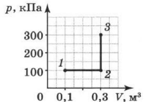
4. На графике представлена зависимость давления  $p$  газа от объема  $V$  при переходе газа из состояния 1 в состояние 3. Определите работу, совершённую газом. 1) 10 кДж; 2) 20 кДж; 3) 30 кДж; 4) 40 кДж.
