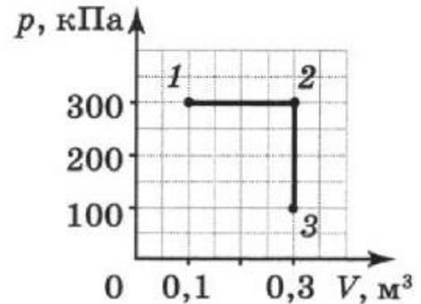
3. На графике представлена зависимость давления  $p$  газа от объема  $V$  при переходе газа из состояния 1 в состояние 3. Определите работу, совершённую газом.
